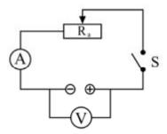
1.2.1 Nach dem Schließen des Schalters wird der Widerstand R<sub>a</sub> schrittweise verringert. Es ergeben sich folgende Messwerte:
