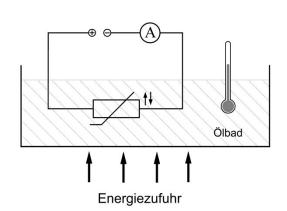
1.1.1 In dem Versuch ergeben sich für die Stromstärke I in Abhängigkeit von der Temperatur θ folgende Messwerte:
