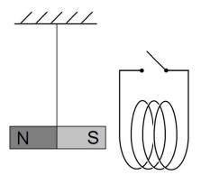
Die Gesamtpendelzeit ist bei geschlossenem Schalter deutlich kürzer als bei offenem Schalter.
