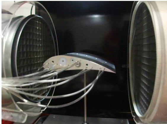
Abbildung 6: Flügelprofil im Windkanal
