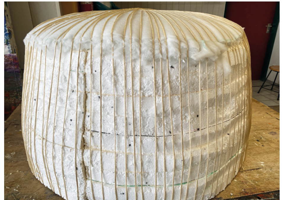
1 und 2 Herstellung eines Prototyps im Maßstab 1:1 aus Styropor und Füllmaterial, umspannt mit Schnüren
