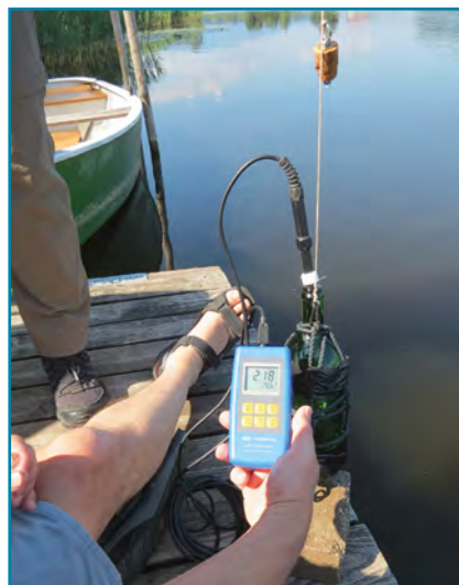
Mit der Sauerstoff-Elektrode wird der Sauerstoff-Gehalt gemessen.
