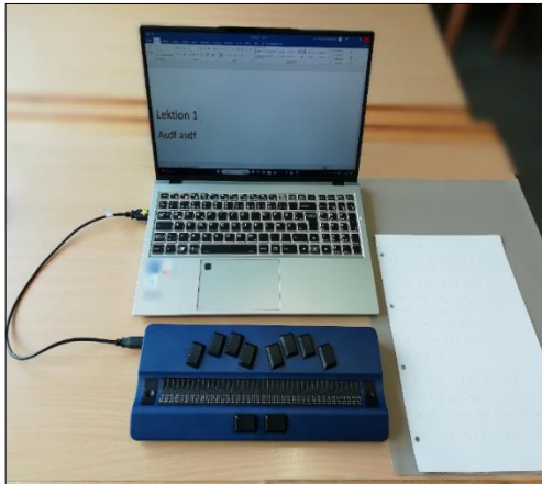
Abbildung 8. Laptop mit Braillezeile und Screenreader Quelle: ISB
