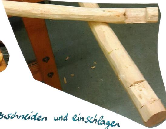
6. Löcher bohren, Holznägel zuschneiden und einschlagen
