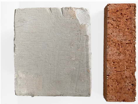
Abb. 18: Kalziumsilikatstein zur Dämmung und Schamottestein als Wärmespeicher im Ofenbau
