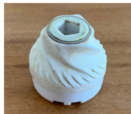
Abb. 16: Keramikmahlwerk einer Pfeffermühle
