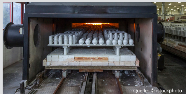
Abb. 47: Massenware beim Durchlaufen eines Tunnelofens
