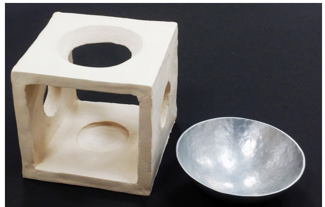
Abb. 38: Duftlampe mit Keramikstäbchen: Materialkombination aus Metall und weiß brennendem Ton. Der Tongegenstand wurde mit Hilfe der Plattentechnik gefertigt.
