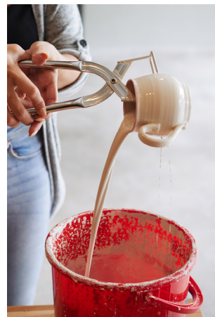
Abb. 55: Auftrag der Glasur durch Gießen Quelle: © istockphoto
