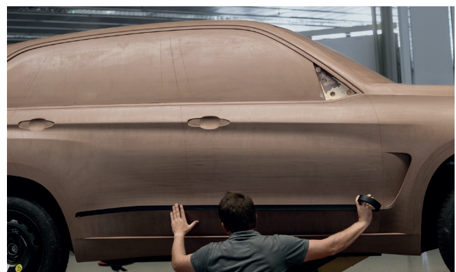
Abb. 35: Modellieren an einem Automobil-Designmodell im Maßstab 1:1
