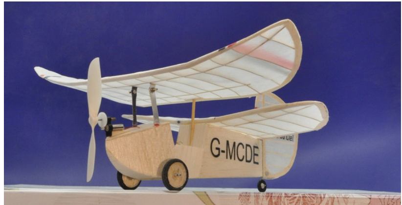
Abb. 6: Modellflugzeug mit Tragflächen, die mit Kashmir-Papier 11 g/m 2 bespannt sind, Gesamtfluggewicht 9,5 g.
