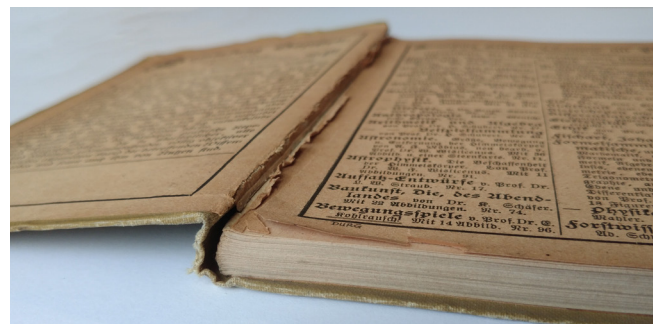
Abb. 16: Vergilbtes und brüchiges Papier aus Holzstoff
