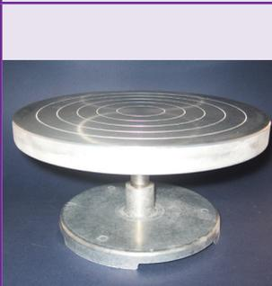
Abb. 28: Ränderscheibe aus Zinkdruckguss
