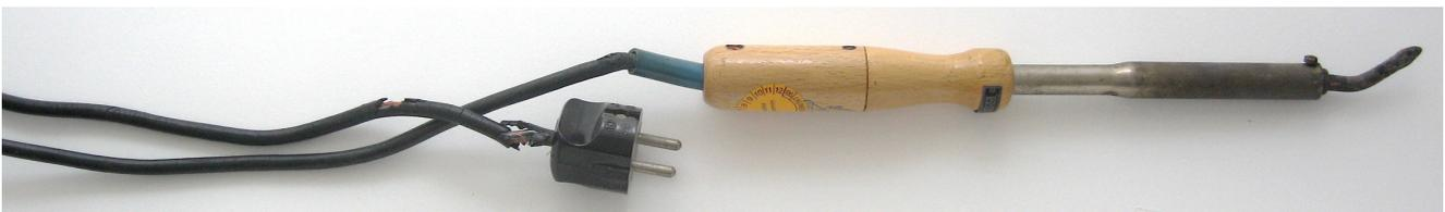
Abb. 65: LötKolben mit lebensgefährlichem Anschlusskabel
