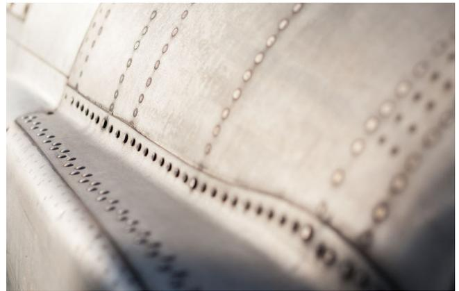
**Abb. 9:** Vernietete Aluminiumaußenhaut eines Flugzeugs
