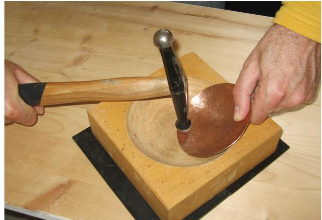
Abb. 76: Treiben einer Kupferronde in einer Treibmulde
