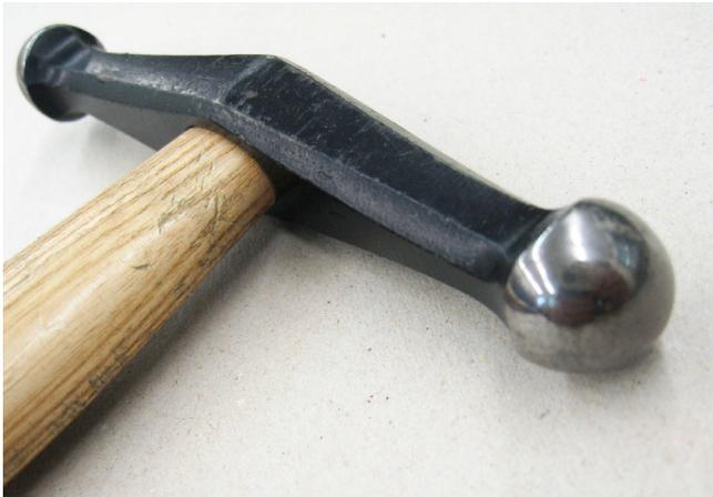
Abb. 75: Treibhammer mit Kugelköpfen
