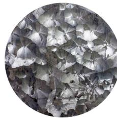
Abb. 13: Kristalline Struktur von Zink nach dem Galvanisieren auf einer Eisenoberfläche
