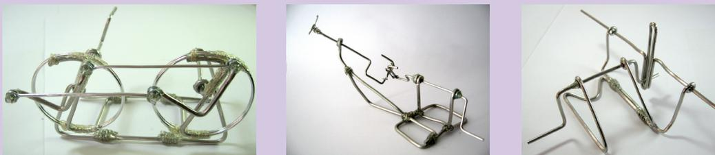
**Abb. 91–93:** Parallelschubkurbel, Kardanwelle, Kreuzschubkurbel
