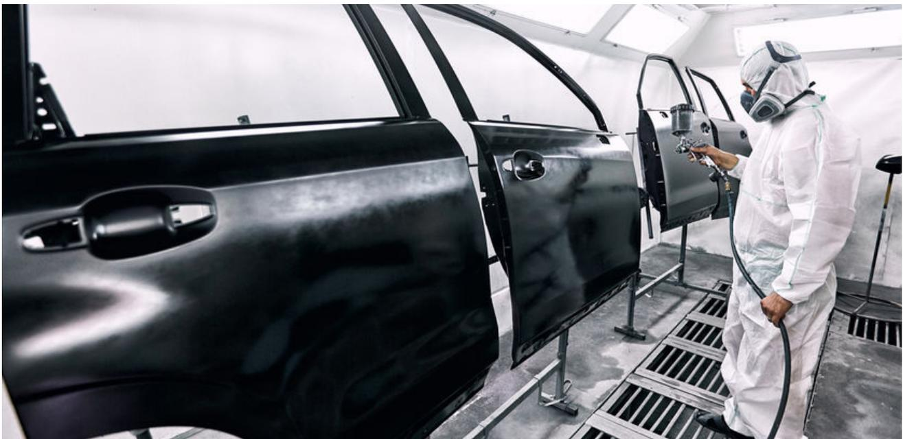
Abb. 78: Autolackierung in staubfreiem Raum
