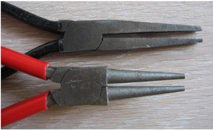
Abb. 59: Flachzange und Rundzange
