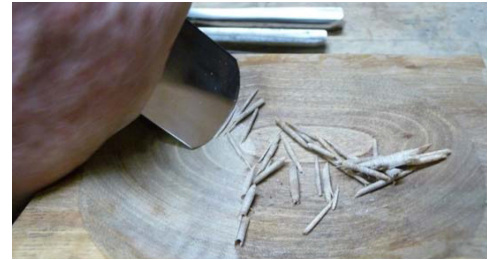
Abb. 31: Der Einsatz des Balleisens beim Ausarbeiten einer Mulde (Nussbaumholz)
