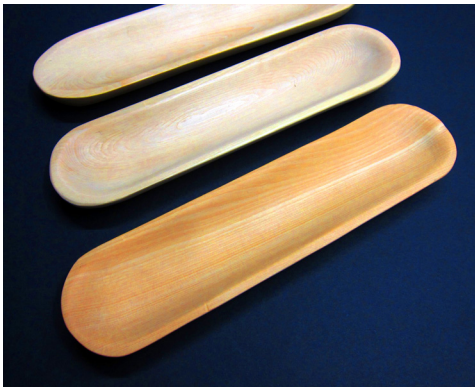
Abb. 46 (links), 47, 48: Subtraktiv gearbeitete Holzschalen mit gründlich nachbearbeiteter Oberfläche
