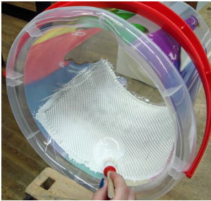
Abb. 53–56: Herstellung eines Lampenschirms zur ausschließlichen Verwendung mit LED-Leuchten
