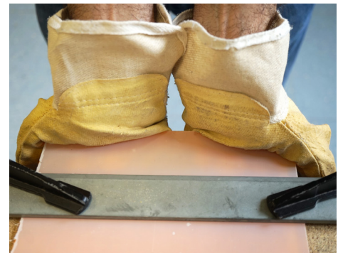
Abb. 39: Die Acrylglasplatte wurde gedreht und über die Tischkante hinaus neu eingespannt. Der Bruch erfolgt durch einen kurzen Impuls.
