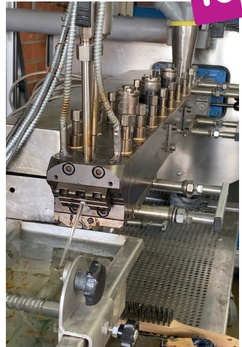
Abb. 13: Ein dünner Schlauch tritt aus dem formgebenden Werkzeug aus und durchläuft die Kalibrierung
